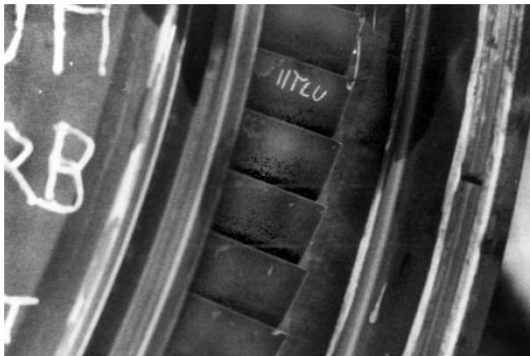
شکل (۲-۴۳) پره‌های متحرک جدید بعد از سه و نیم سال کار
